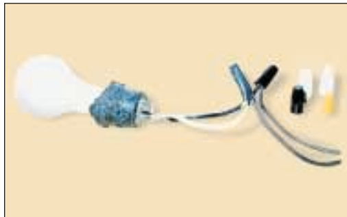
La chaleur du culot (socket) d'une ampoule électrique peut atteindre 343 °C (650 °F), une température plus que suffisante pour faire fondre une douille en caoutchouc.
